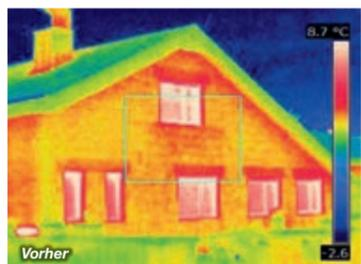
Hoher Energieverlust bei einer ungenügend gedämmten Fassade.
