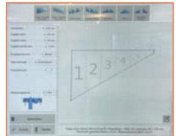
\* Die Touch-Steuerung für die automatische Scharenberechnung.
