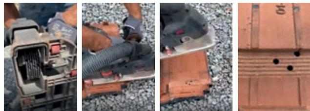
In Verbindung mit 7 Trennscheiben Laser Turbo-S-Cut 115 x 22,23 mm und dem Distanzstückset lassen sich mit der AGP CG125 Aussparungen (Fräsbreite max. 30 mm) an Dachziegeln oder Betondachsteinen erstellen.
