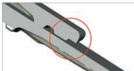
Die neu entwickelte Schattenfuge vermindert kapillares Einziehen von Wasser in die Höhenüberdeckung.
