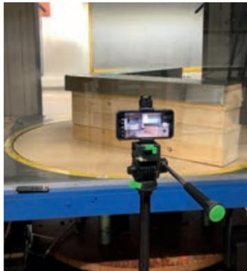
Modell der Attikaabdeckung zur Strömungsvisualisierung: Die mit Enkolit® auf einer ca. 500 mm hohen Holz-UK befestigte 90°-Attika-Außenecke besteht aus 0,7-mm-Titanzink. Die Profilbreite beträgt 300 mm – der Überstand ca. 25 mm. Die senkrecht nach unten abgekannten Schenkel sind 100 mm hoch.
