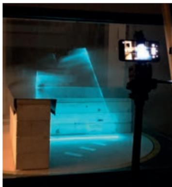
Der Prüfkörper steht auf einem Drehteller. Spezielle Leuchtkörper und das Einblasen von Kunstrauch machen die Windströmung sichtbar.
