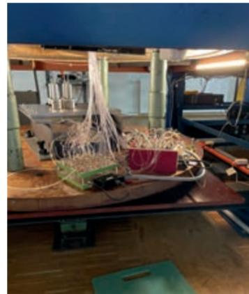
Unter dem Drehteller führen zahlreiche Kabel zu den Sensoren im Prüfkörper.
