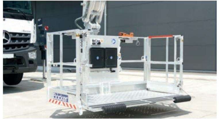
Für den freien Zugang zum Arbeitsbereich kann die vordere Längsseite des neuen Personenkorbs komplett geöffnet werden. © Foto: Böcker
