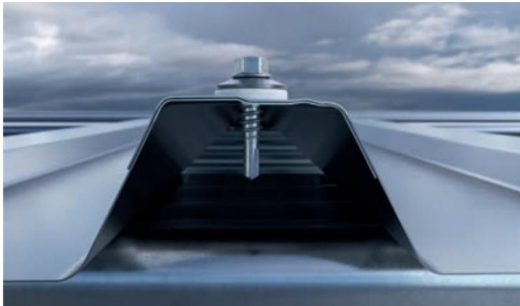
Mit den neuen Befestigern tightlapper bietet SFS nun eine einfache und effiziente Lösung an, um Dach- und Fassadenelemente miteinander zu verbinden. Sie sind in allen Farben erhältlich und dank der innovativen AV-Shaped Dichtscheibe aus Edelstahl und ultra-softem EPDM absolut wasserdicht und anpassungsfähig. Aufgrund der hohen Flexibilität deckt sie unterschiedliche Klemmbereiche ab und gleicht Baustellentoleranzen problemlos und zuverlässig aus. © Foto: SFS
