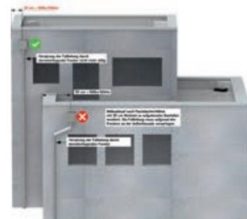
Abbildung 5: Im Vergleich zu herkömmlichen Attika-Abläufen kann beim Einsatz der Attika-Eck-Abläufe auf Versprünge der Falleitungen verzichtet werden, da die Rohrleitung nah zur Gebäudekante herausgeführt werden kann.
