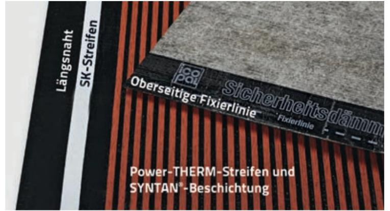
Elastomerbitumenbahn Polar, werkseitig auf den Dämmstoff kaschert, mit Icopal Sicherheitsnaht und PowerTherm Profil.
