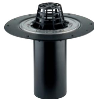
Der Schraubflansch Sanierungsgully besteht aus einem senkrechten Grundkörper, der mit beiliegender Lippendichtung in den vorhandenen Altgully eingeschoben wird. Er passt für Dachbahnen ab 1,3 mm Dicke und ist für diese Aufgabe besonders geeignet.
