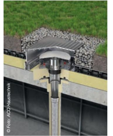
Öffnungen im Dach benötigt. Bei Kernbohrungen wird nur eine Kernbohrung von 160 mm mit Isolierung für die Flachdachabläufe Variant-Flex in den Nennweiten DN 50 – DN 100 mit Stutzenneigung 90° benötigt.
