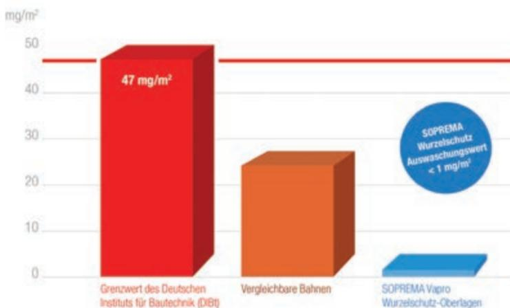
SOPREMA Vapro Wurzelschutz-Oberlagen liegen mit einem Wert von unter 1 mg/m<sup>2</sup> für die Wurzelschutzauswaschung deutlich unter dem Grenzwert des Deutschen Instituts für Bautechnik (DIBt) von 47 mg/m<sup>2</sup> und auch unter den Werten vergleichbarer Bahnen.
