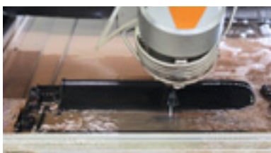
Schneiden des Dachziegels mit 3.500 bar Wasserstrahl.
