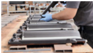
Kleben des beschnittenen Ziegels mit Spezialkleber.
