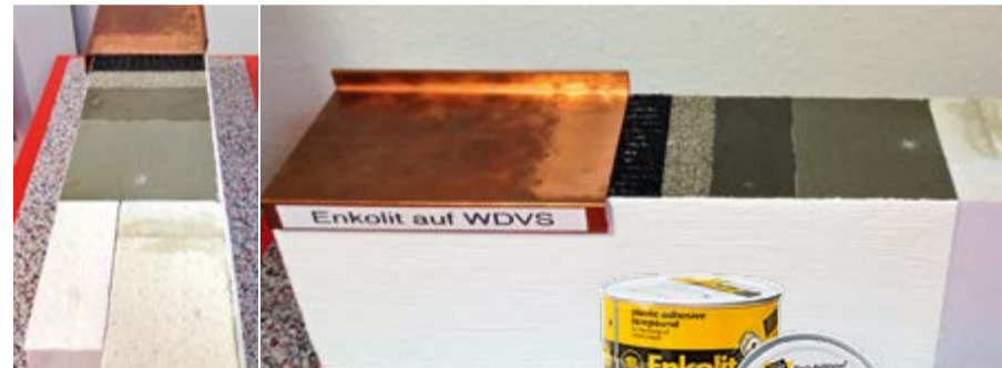
Ein Materialmuster veranschaulicht die Einsatzmöglichkeit des Blechkaltklebers Enkolit® zur direkten Verklebung auf Wärmedämmelementen.
