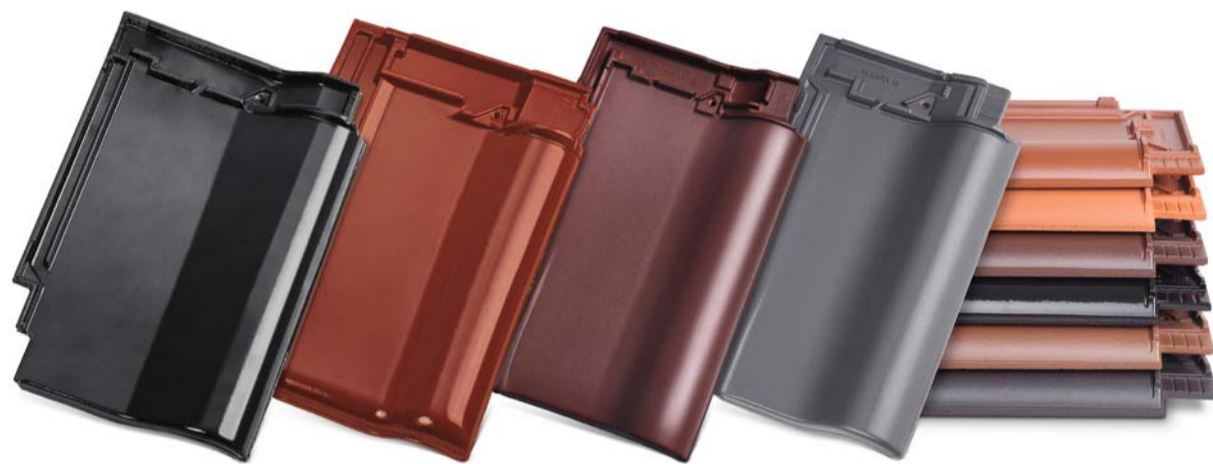
Der Flachdachziegel Alegra kommt als Quartett in vier verschiedenen Formaten: Je nach Größe benötigt man pro Quadratmeter Dachfläche ca. 8, 10, 12 bzw. 15 Ziegel. Vier Oberflächen und 24 Farben lassen nahezu keine Wünsche offen.
