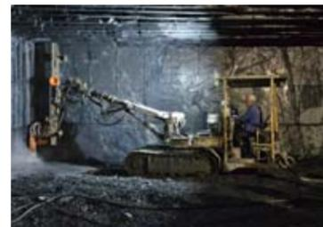
Ein beeindruckendes Bild: Mit schwerem Gerät und lautem Sägergeräusch frisst sich das Sägeblatt Stück für Stück in den schwarzen Schiefer.
