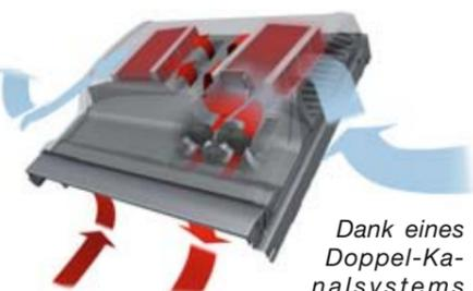
Dank eines Doppel-Kanalsystems mit Wärmeregeneratoren geht mit Velux Smart Ventilation die Wärme mit der abziehenden Raumluft nicht verloren, sondern lässt sich bis zu 76 Prozent zurückgewinnen.
