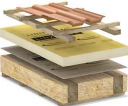
Die Dicke der Aufdachdämmung ist bei dieser Konstruktion abhängig von den wärmeschutztechnischen Eigenschaften der raumseitigen Schichten. Je dicker die Aufsparrendämmung, desto sicherer wird der Aufbau. Der Einsatz von PAL oder PGV Aufsparrendämmungen ist bei vorhandenen/neuen Zwischensparrendämmungen bis 160 mm und einer WLS  $\geq 035$  bereits ab einer Dicke von 80 mm möglich.
