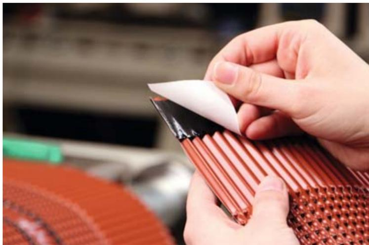
Die modifizierte Rezeptur des in 2,5 Zentimeter Breite und 1,5 Millimeter Dicke aufgetragenen Roof Grip Extreme-Klebandes verfügt über eine dreifach höhere Kleb- und Haftkraft gegenüber üblicherweise verwendetem Butyl.
