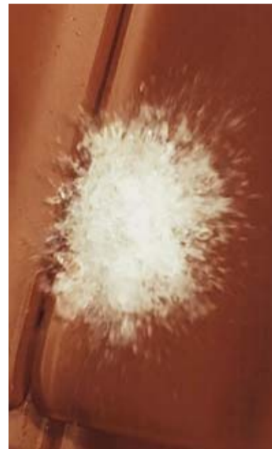
Die Kamera im Testaufbau dokumentiert die Hagelsicherheit des E 58 PLUS®. Er ist einer der robustesten Ziegel bei Hagel.
