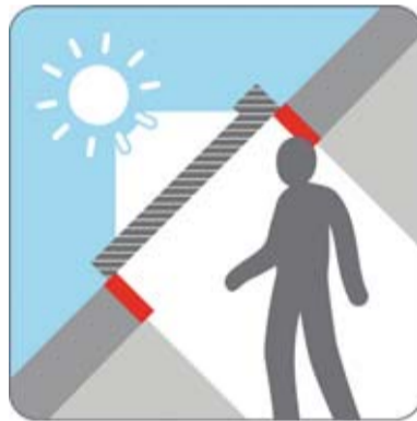
Durch die Erneuerung der Innenverkleidung lassen sich Lichteinfall und Kopffreiheit verbessern sowie die Dämmung und die Anschlüsse ans Dach optimieren.
