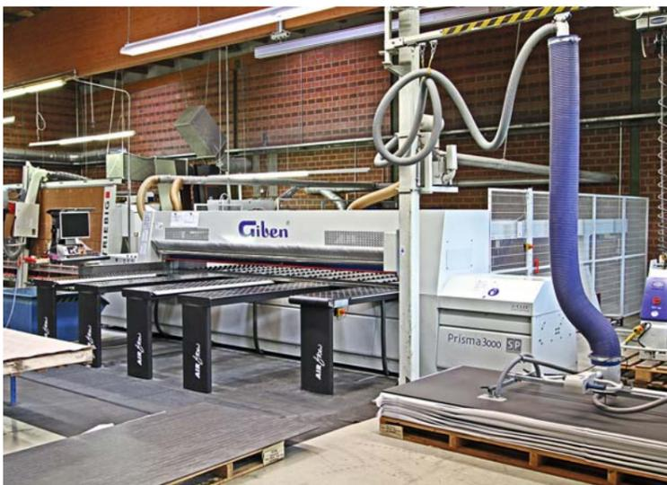
Die neue Plattensäge für Fassadenzuschnitte bei der Mörk KG in Villingen-Schwenningen.
