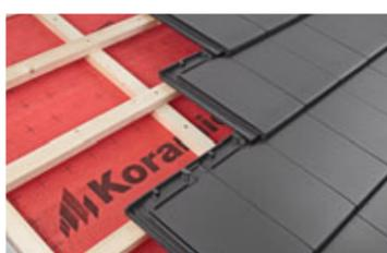
Der Flachziegel Plano 11 in eleganten und modernen dunklen Farbtönen spricht besonders Architekten an. Mit seinem 20 Millimeter großen Kopffalz-Verschiebbereich ist eine flexible Lattweitereinteilung möglich. Seine Decklänge variiert zwischen 35,5 und 37,5 Zentimetern. Er wird mit abgestimmtem Koramic-Systemzubehör auf den Markt gebracht.
