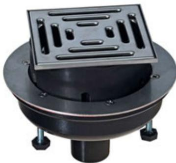
Der neue „Profi“-Komplettablauf von Grumbach wurde für Balkone und Terrassen entwickelt. Er besitzt einen integrierten frostsicheren Geruchsverschluss und einen höhenverstellbaren Einlaufrost aus Edelstahl.
