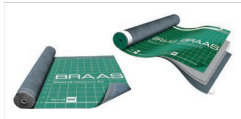
Divoroll Maximum RU: Die hoch reißfeste, diffusionsoffene Unterdeckbahn mit patentierter Klebezone für regensichere Unterdächer ist gleich fünffach gut (v. o. n. u.): Spezialbeschichtung, Hochleistungsvlies, Funktionsmembran, Verstärkungsgitter und Schutzvlies.
