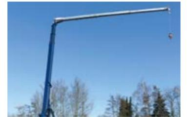
Turmdrehkrantfunktion: Mit vertikal aufgerichtetem Mast und dem Ausleger im rechten Winkel teleskopiert der Kran die Last direkt in die Etage hinein.
