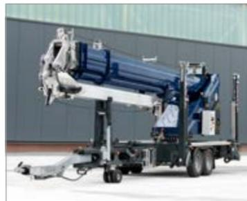
Der AHK 36e kann als erster Akku-Anhängerkran dauerhaft im 230 V-Steckdosenbetrieb arbeiten.
