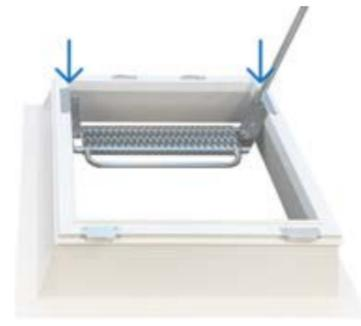
Die esserstep Austrittsstufe wird von oben im Aufsetzkranz verschraubt statt, wie marktüblich, unter dem Aufsetzkranz befestigt.
