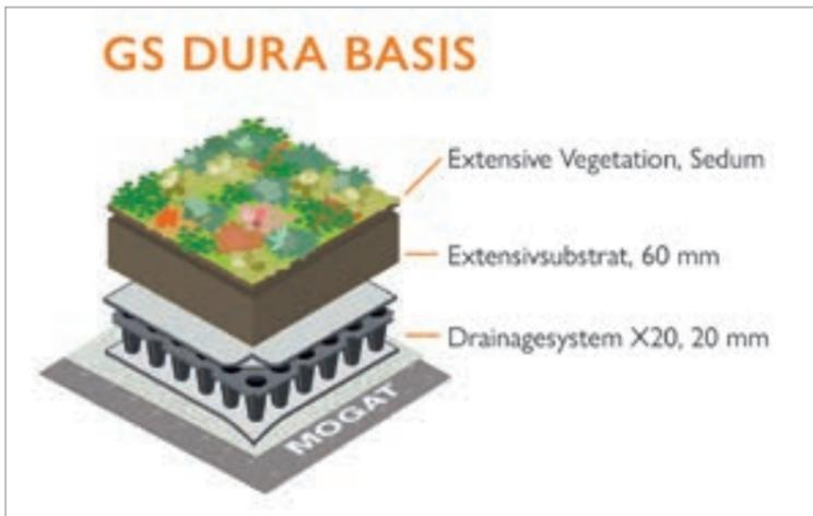
GS Dura Basis, GS Dura Basis+, GS Dura Premium, GS Dura Premium+: Mit GS Dura steht ein modulares Dachbegrünungssystem mit einer Vielzahl an objektbezogenen Variationsmöglichkeiten zur Verfügung – hier abgebildet, GS Dura Basis (bis zu 21,5 Liter Wasserspeicher/m<sup>2</sup>). © Fotos: Mogat
