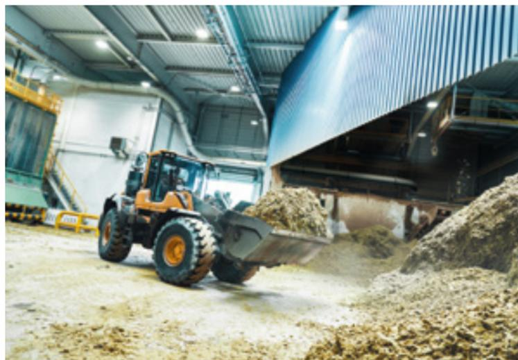
Steinwolle-Verschnitt von Baustellen wird in den Werken der DEUTSCHEN ROCKWOOL aufgearbeitet und mit neuem Rohmaterial verschmolzen. So entsteht aus altem wiederum neues Steinwolle-Dämmmaterial.
