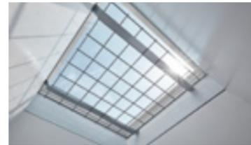
Mit einer geprüften Fallhöhe 2,40 Metern und einer Maschenweite von 100 mm entspricht das RSM dabei dem europäischen Standard. Es ist zudem nach Einbau des Aufsetzkranzes zertifiziert durchsturzicher nach GS-BAU-18:05-2020 und erfüllt die Primäranforderung der Arbeitsstättenrichtlinie ASR A2.1.
