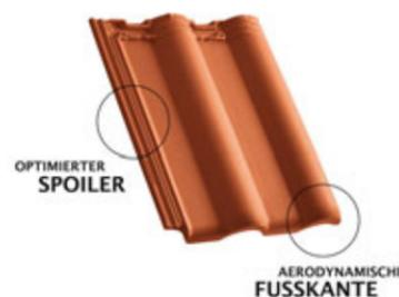
Tuning für den „MAXIMA“, hier in Naturrot: links der optimierte Spoiler, rechts die aerodynamische Fußkante. Beide Verbesserungen erhöhen die Regeneintragssicherheit.
