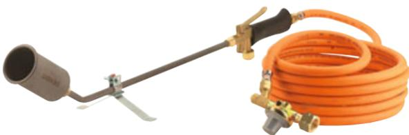
Aufschweißbrenner Titan: 850 mm Länge, 4-bar-Druckregler mit Schlauchbruchsicherung, Propan-Hochdruckschlauch, Drehkupplung
