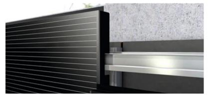
Der verstellbare Auflageteil des Halters lässt sich bequem per Schrauben auf die benötigte Neigung und Montagehöhe einstellen. Dazu sind keine Distanzscheiben oder ähnliche Bauteile erforderlich. Da der Halter variierbar in der Traglattung eingehängt werden kann, ist auch keine Befestigung auf dem Sparren erforderlich.
