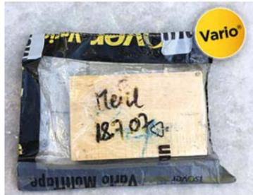
Der in Vario verpackte Holzklötz ist nach 10 Jahren noch völlig unversehrt. Beide Holzteile wurden mit Vario Multitape verschlossen.
