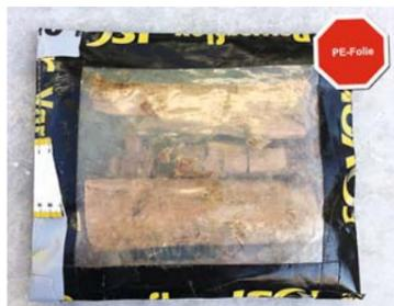
Holzfäule und Schimmel haben dem in PE-Folie gelagerten Holz deutlich zugesetzt. Fotos: ISOVER
