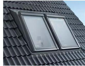
Mehr Kopffreiheit und Ausblick bietet auch die Lichtlösung „Raum“. Durch den Einsatz des Aufkeilrahmens rückt die Oberkante des Fensters weiter nach außen, sodass Mieter oder Eigentümer auch bei Dächern mit einer Neigung von weniger als 35 Grad bequem vor dem Fenster stehen können.
